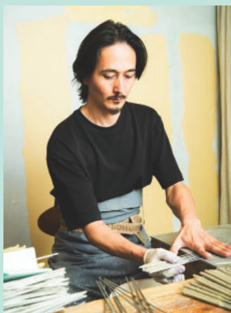
工房で作業する檜さん。専用の串に灯芯を差し、回しながら蠟燭を塗っていく。
