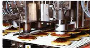
主力商品の「全自動どら焼機」。お菓子メーカーごとに異なるレシピにも対応します。
