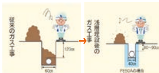
【浅層埋設・小幅掘削】
