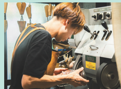
革靴のソールを削る篠田さん。修理の前の解体作業はどのように作られているかをよく見ながら慎重に行い、全て手作業で進めていきます
